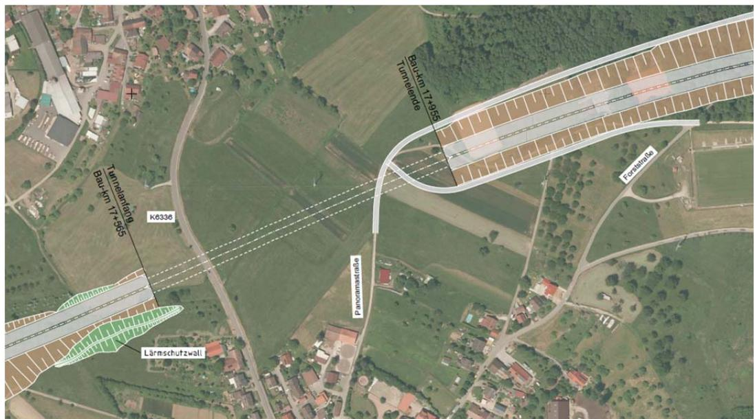
Abbildung 13: Lösungsvorschlag mit 390 m langer Überdeckung und Schutzwall
