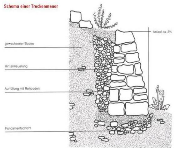
Die Trockenmauer soll eine Länge von etwa 67 m, eine Höhe von 1,5 m und am Mauerfuß eine Breite von 1 m aufweisen. Für die Errichtung der Mauer ist der Oberboden auf der Fläche abzutragen. In Abständen von ca. 10 m sind insgesamt 4 - 5 jeweils 1,2 m tiefe und frostsichere Winterquartiere für Reptilien mit einer Grundfläche von 5 m<sup>2</sup> herzustellen und mit grobem und durchlässigem Gesteinsmaterial zu verfüllen
