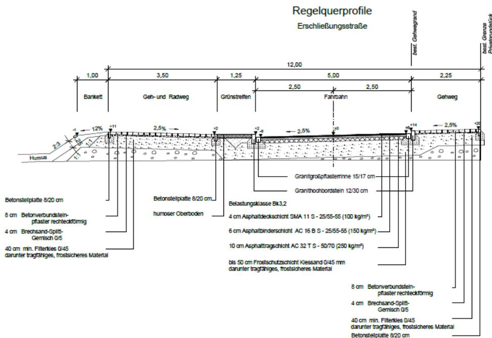
Umbau Römerstraße: Regelquerprofil, ohne Maßstab. Quelle: dwd Ingenieur GmbH, 05.03.2020
