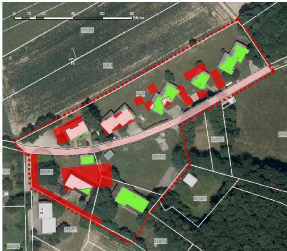
Abbildung 15: Boden Ver- und Entsiegelung (rot = Neuversiegelung (1.334 m<sup>2</sup> davon 290 m<sup>2</sup> Weg mit wassergebundener Decke), grün = Entsiegelung (660 m<sup>2</sup>), rosa = bleibt versiegelt (1.276 m<sup>2</sup> davon 841 m<sup>2</sup> Straße))
